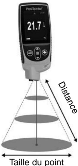
Le rapport entre la distance et la taille de la cible correspond à la relation entre le diamètre de la zone mesurée et la distance de l'instrument par rapport à la zone. Lorsque la distance (D) à la cible mesurée augmente, la taille de la zone mesurée (S) devient plus grande. Le rapport D: S du **PosiTector IRT** est de 5.7:1. Par exemple, lorsque l'instrument est à 100 cm (40 pouces) de la cible, la taille du point sera de 18 cm (7 pouces) de diamètre.
