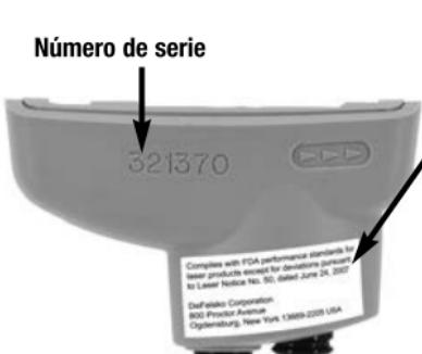
Etiqueta de identificación y calibración del fabricante.
