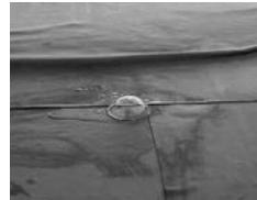
Cuando se haya identificado una fuga, la prueba podrá interrumpirse pulsando el botón
