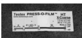
Al colocar la cinta comprimida (réplica) en el **PosiTector RTR H** dará una medida del promedio de la altura máxima entre pico y valle del perfil rugoso de la superficie. El medidor sustraerá automáticamente el espesor del sustrato de poliéster de todas las mediciones.
