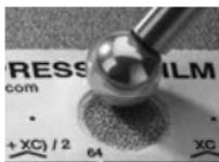
suficiente en círculo y frote en sentidos transversales para producir una réplica con un aspecto de grano uniforme. Normalmente se requieren de 30 a 60 segundos para comprimir completamente todas las partes de la película en la mayoría de las superficies. En general, el exceso de compresión es más seguro que demasiado poca. Una vez finalizado el perfilado retire la cinta de réplica de la superficie.
