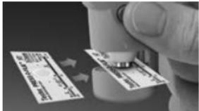
Richten Sie zur Positionierung des Replicafilms (Tape) die beiden (auf dem Replicafilm aufgedruckten) Punkte auf die Pfeile an den Seiten der Messöffnung aus.
