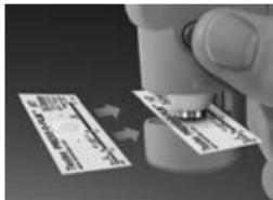
Para colocar la cinta, alinee los dos puntos (impresos en la cinta de réplica) con las flechas en ambos lados de la ranura de medición.
