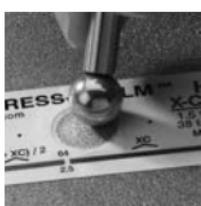
normalement entre 30 et 60 secondes pour comprimer entièrement toutes les parties du film sur toutes les surfaces. En général, il est préférable d'appliquer une compression plus importante que pas assez. Une fois le polissage (ou rodage) terminé, retirer le ruban de réplique de la surface.
