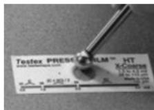
Comprima firmemente la película de réplica utilizando el extremo redondeado de la herramienta de pulido de acero inoxidable. Aplique una presión
