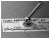
Comprimer fermement le film de réplique en utilisant l'extrémité arrondie de l'outil de polissage en acier inoxydable inclus. Appliquer une pression suffisante en procédant à un mouvement de frottement circulaire et en xy pour produire une réplique avec un aspect à granulométrie uniforme. Il faut
