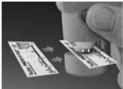
Pour positionner le ruban, aligner les deux points (imprimés sur le ruban de réplique) avec les flèches situées sur les deux côtés de l'ouverture de mesure.
