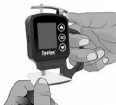
**注意：**在打开测量仪电源、归零（第 5 页）之前，或在测量后取下复制品时测量仪不显示 -50 微米 (-2.0 密耳) 时，请清洁砧座。
