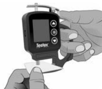
**참고:** 영점을 조정(p.6)하거나, 측정 후 복제 테이프를 제거할 때 게이지가  $-50 \mu\text{m}$ (-2.0 mils)을 표시 하지 않으면 게이지를 켜기 전에 앤빌을 청소합니다. 청소 후 **≡** 버튼을 눌러 Testex 디지털 마이크로미터의 전원을 컵니다.
